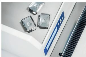
Um ausreichend Formen bereit zu halten, hat die MPS W einen Vorwärmbereich für bis zu 500 Einbettformen. Temperatur frei wählbar bis 80 °C.
