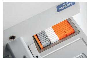
Zwei beheizte Schalen, für 120 Standardkassetten und 250 Einbettformen, sind im hinteren Arbeitsbereich bequem erreichbar.
